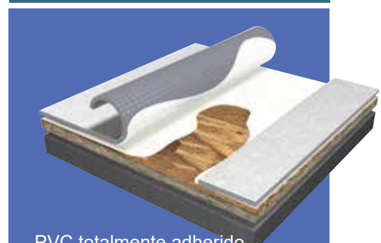
PVC totalmente adherido con adhesivo de contacto WBBA 2000
