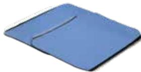
**ESQUINAS INTERIORES / EXTERIORES PRECORTADAS** Ideal para instalar esquinas interiores y exteriores. Consiste en material de tapajuntas EPDM sin curar de .060 pulgadas (1.5 mm) de espesor laminado a cinta de caucho butílico curado y enrollado sobre un revestimiento de liberación de polietileno que proporciona .090 mils (2.25 mm) de espesor total.
