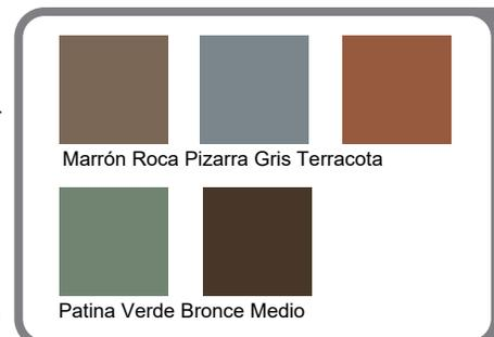
Las membranas de colores especiales se desvanecerán con el tiempo principalmente debido a la parte ultravioleta de la luz solar. La mayoría de las superficies de los techos están expuestas a la luz solar variable, algunas áreas serán más susceptibles a los cambios de color causados por la decoloración de los rayos UV. Las garantías de las membranas de colores especiales no cubren la decoloración de los colores.
