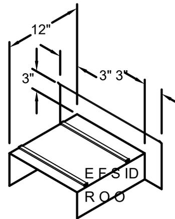
VERSIÓN DE PLACA DE EMPALME DE TAPAJUNTAS EN LA PARED FINAL (SE MUESTRA A LA DERECHA) (DISPONIBLE SOLO EN .040" SOLDADO, PINTADO PARA QUE COINCIDA CON LA COFIA)
