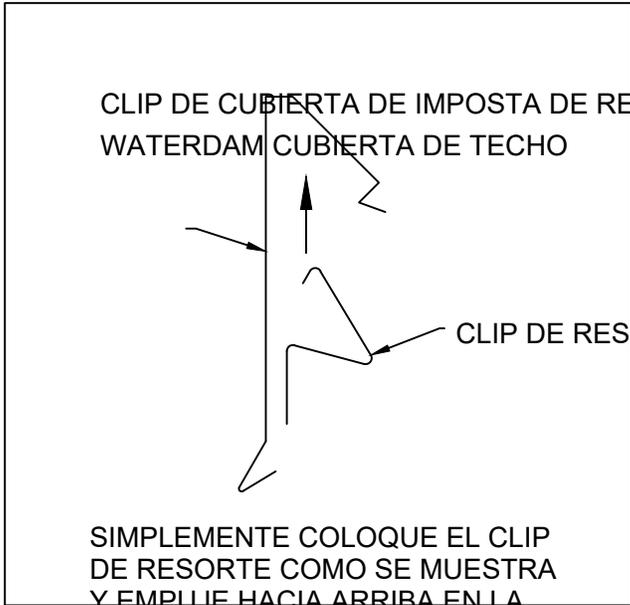
SIMPLEMENTE COLOQUE EL CLIP DE RESORTE COMO SE MUESTRA Y EMPUJE HACIA ARRIBA EN LA CUBIERTA HASTA QUE SE PRODUZCA EL BLOQUEO A PRESIÓN.
