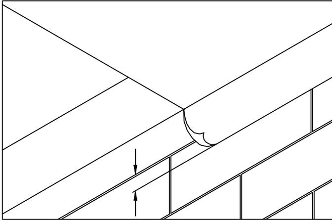
HACIA ABAJO EN LA CARA EXTERIOR DE LA PARED, CUBRIENDO COMPLETAMENTE LA(S) CLAVADORA(S) DE MADERA TRATADA(S). PERMITA 1 2" DE EXCESO DE MEMBRANA.
