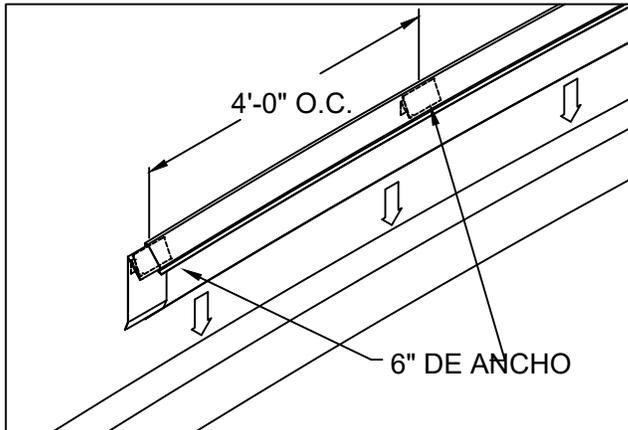
2. INSTALE SECCIONES DE CUBIERTA DE FASCIA DE 12'-0". INSERTE UNA PLACA DE EMPALME Y UN RESORTE DE 6" DE ANCHO
