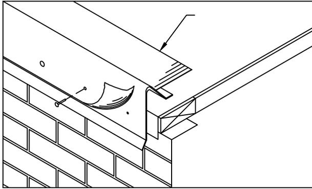
COLOQUE LA MEMBRANA STRIP-IN HACIA ARRIBA Y HACIA ABAJO
