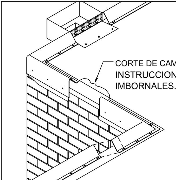
A CONTINUACIÓN, LOCALICE E INSTALE IMBORNALES. VER PÁGINAS 4 Y 5 PARA OBTENER INSTRUCCIONES DETALLADAS SOBRE LA INSTALACIÓN DE IMBORNALES. LUEGO INSTALE LAS SECCIONES DE 12'-0" DE
