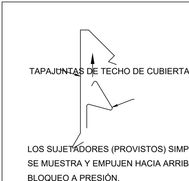
TAPAJUNTAS DE TECHO DE CUBIERTA DE IMPOSTA WATERDAM
