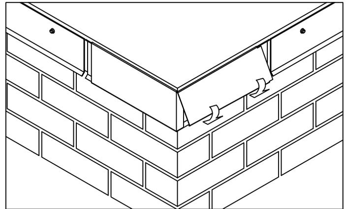
**3. Instalación de barras formadas 4. Cubiertas de inglete de fascia**
