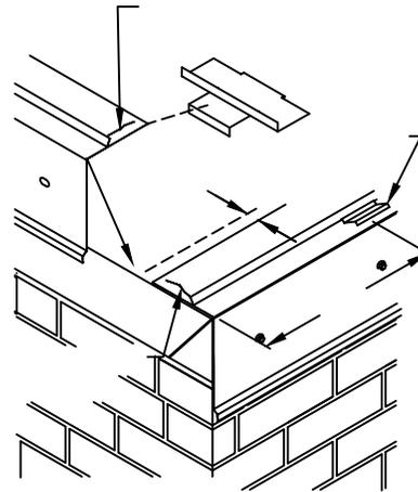
EN LA ESQUINA DEL EDIFICIO, IDENTIFIQUE LA "OREJA DE PERRO" O LA SUPERPOSICIÓN DE LA TIRA INTERMITENTE. FIJE UNA SECCIÓN DE 12'-0" DE RIEL BASE, PREPARADA CON MASILLA/SELLADOR COMO SE MUESTRA EN EL PASO #2, A LA CARA OPUESTA, CON EL EXTREMO NIVELADO CON EL BORDE DE LA PARED. FIJE EN SU LUGAR A TRAVÉS DE LAS RANURAS DEL RIEL DE 12" O.C. CON LOS SUJETADORES PROVISTOS.
