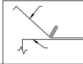
BORDE DE LA PARED. FIJE EN SU LUGAR A TRAVÉS DE LAS RANURAS DEL RIEL DE 12" O.C. CON LOS SUJETADORES PROVISTOS.
