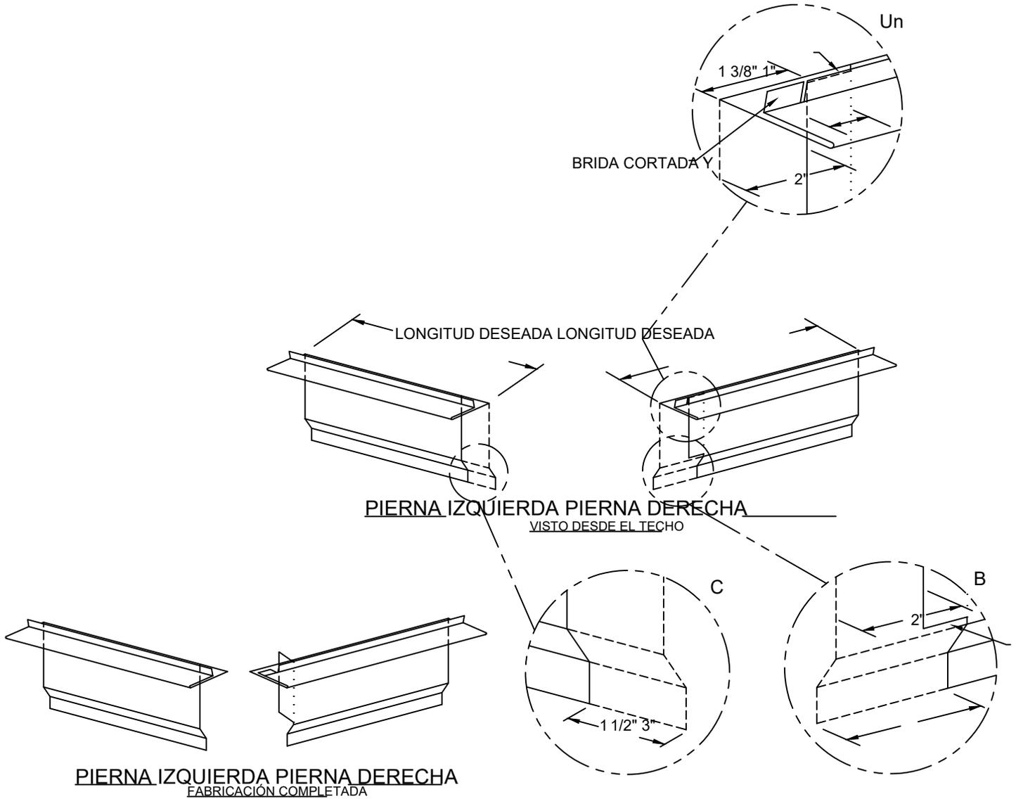
PARA LA PIERNA DERECHA, VEA EL DETALLE A: EN LA BRIDA SUPERIOR, CORTE LA HENDIDURA 1 3/8" DESDE EL EXTREMO Y GOLPEE HACIA ABAJO. RECORTE LA CARA FRONTAL 2" Y LA CARA DE HENDIDURA 1" COMO SE MUESTRA. DETALLE B: EN LA PARTE INFERIOR DE LA BRIDA RECORTE TRASERO 3". CARA DE CORTE 1" CREANDO UNA PESTAÑA DE 1". DOBLA LA LENGÜETA HACIA AFUERA 90°. PARA LA PIERNA IZQUIERDA- DETALLE C: RECORTE TODA LA CARA Y LA BRIDA INFERIOR HACIA ATRÁS 1 1/2" COMO SE MUESTRA.
