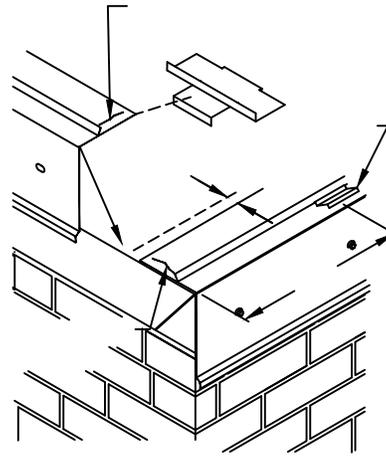
EN LA ESQUINA DEL EDIFICIO, IDENTIFIQUE LA "OREJA DE PERRO" O LA SUPERPOSICIÓN DE LA TIRA INTERMITENTE. FIJE UNA SECCIÓN DE 12'-0" DE RIEL BASE, PREPARADA CON MASILLA/SELLADOR COMO SE MUESTRA EN EL PASO #2, A LA CARA OPUESTA, CON EL EXTREMO NIVELADO CON EL
