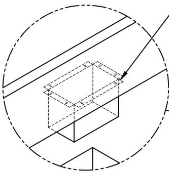
DETERMINE LAS UBICACIONES DE LOS ENCHUFES Y CORTE EL AGUJERO EN EL CAMPO DE UNA MANERA ORDENADA Y PROFESIONAL. INSERTE LA SALIDA KYNAR DE ALUMINIO, FÍJELA CON DOS REMACHES EN CADA BRIDA Y SELLO, CON SALIDA DE CANALÓN SELLADOR NO CURABLE (SE MUESTRA IG-B)
