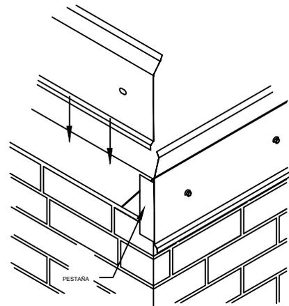
CONSULTE LA PÁGINA 5 PARA LA PREPARACIÓN DE INGLETES. FIJE EL RIEL DE LA BASE DE INGLETE A LA(S) CLAVADORA(S) A TRAVÉS DE LAS RANURAS DEL RIEL DE LA BASE CON LOS SUJETADORES PROVISTOS.
