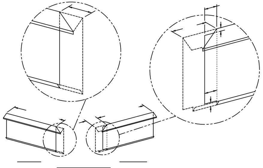
PASO 13 - FABRICACIÓN DE LA CUBIERTA DE INGLETE INTERIOR (CORTE LA CUBIERTA A LA LONGITUD DESEADA)
