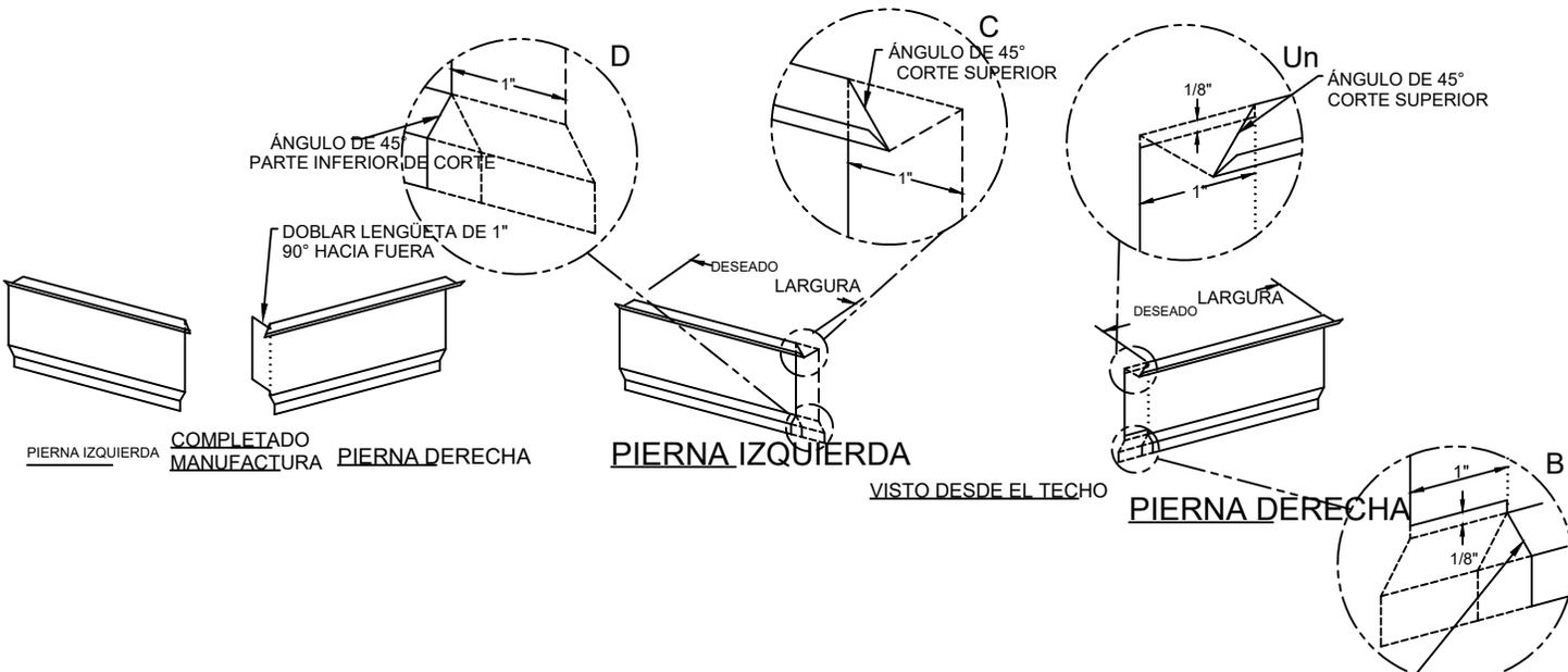
SE MUESTRA PARA CREAR PESTAÑA. RECORTE LA BRIDA SUPERIOR HACIA ATRÁS EN UN ÁNGULO DE 45°. DETALLE B: CORTE PARTE INFERIOR DE CORTE CARA INFERIOR DE 1/8" COMO SE MUESTRA Y CONTINÚE CORTANDO A UN ÁREA DE PASO DE 45° QUE SE MUESTRA EN BRIDA INFERIOR. DOBLA LA LENGÜETA HACIA ADENTRO 90°. PIERNA IZQUIERDA - DETALLE C: CORTE LA BRIDA SUPERIOR A 45° ÁNGULO. CONTINÚA HACIA ABAJO CON LA CARA. DETALLE D: CORTE LA BRIDA INFERIOR EN UN ÁNGULO DE 45° COMO SE MUESTRA.
