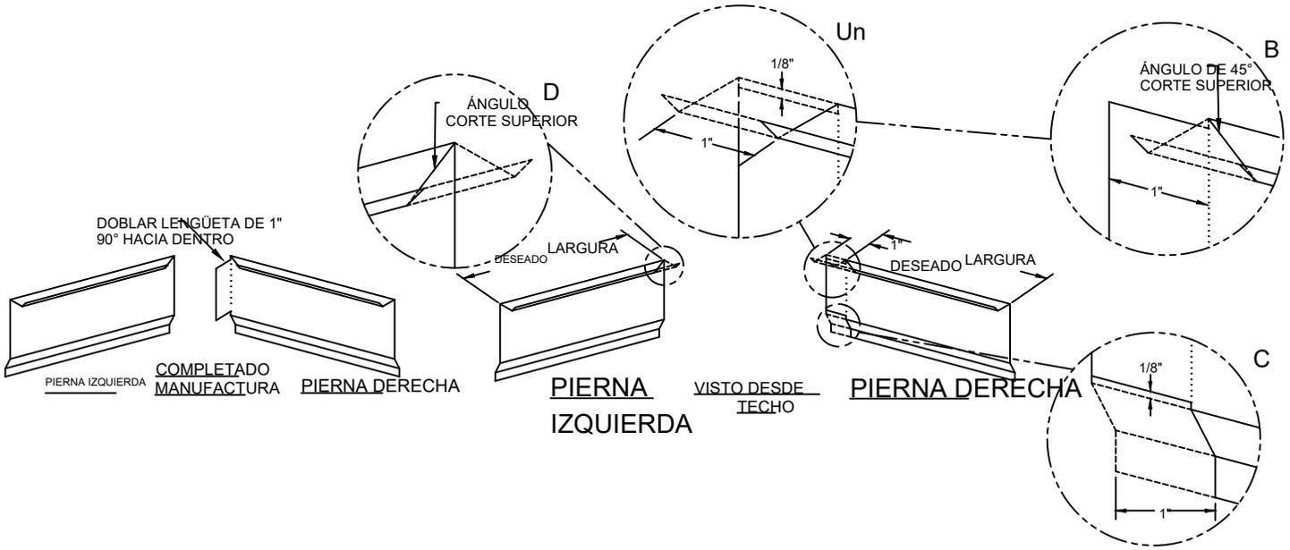
HACIA ABAJO Y 1" HORIZONTALMENTE COMO SE MUESTRA PARA CREAR LA LENGÜETA. DETALLE B: CORTE BRIDA SUPERIOR EN UN ÁNGULO DE 45°. DETALLE C: CORTE LA CARA INFERIOR 1/8" x 1" COMO SE MUESTRA Y CONTINÚA A TRAVÉS DEL ÁREA QUE SE MUESTRA EN LA BRIDA INFERIOR. DOBLAR TABULACIÓN HACIA ADENTRO 90°. PIERNA IZQUIERDA - DETALLE D: RECORTE LA BRIDA SUPERIOR EN UN ÁNGULO DE 45°.
