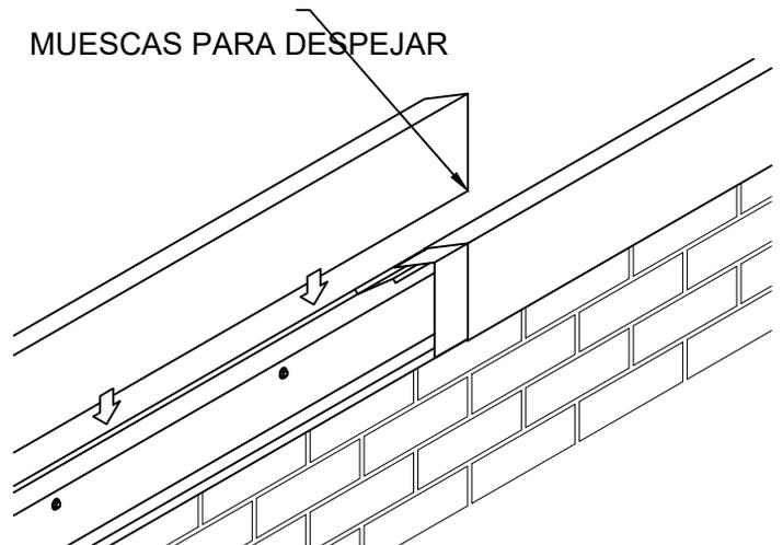
PRESIONANDO HACIA ABAJO CON LA PALMA DE LA MANO HASTA QUE LA CUBIERTA QUEDE COMPLETAMENTE ENGANCHADA EN TODA SU LONGITUD. DEJE UN ESPACIO DE 3/8" ENTRE LAS SECCIONES DE LA CUBIERTA. CORTE EN EL CAMPO DONDE SEA NECESARIO CON UNA SIERRA PARA METALES DE DIENTES FINOS.
