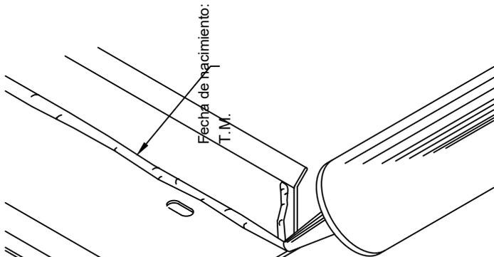
(mínimo 2 x 4) debe estar alineado al ras o extenderse ligeramente más allá del borde exterior de la pared. La fascia se usa como fijación perimetral en diseños de techos donde el producto no está instalado en una línea de flotación.
