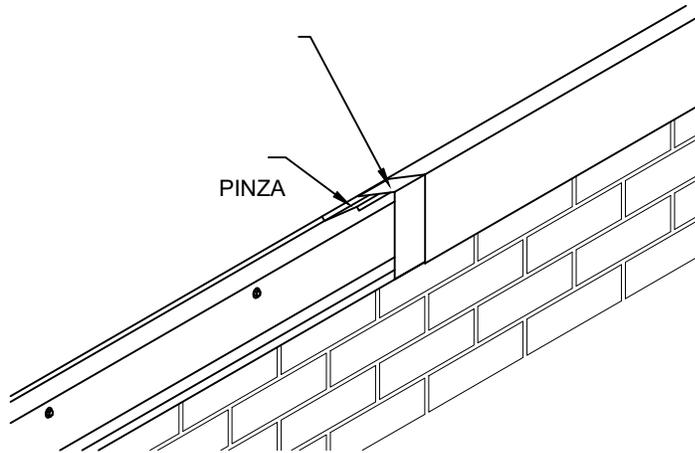
LAS CUBIERTAS DE LA IMPOSTA SE INSTALARÁN DE IZQUIERDA A DERECHA COMO SE VE DESDE LA AZOTEA. COLOQUE LA PLACA DE EMPALME EN EL EXTREMO DERECHO DE LA CUBIERTA. ENCAJE LA CUBIERTA DERECHA EN EL RIEL DE LA BASE APLICANDO PRESIÓN HACIA ABAJO CON LA PALMA DE LA MANO HASTA QUE LA CUBIERTA DE LA FASCIA ESTÉ COMPLETAMENTE ENGANCHADA EN TODA SU LONGITUD. CORTE LAS CUBIERTAS EN EL CAMPO SEGÚN SEA NECESARIO CON UNA SIERRA PARA METALES DE DIENTES FINOS.
