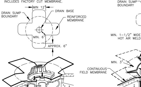
CUT SECTION OF REINFORCED MEMBRANE AS SHOWN AND POSITION INTO DRAIN SUMP. EXTEND MEMBRANE OUT OF DRAIN SUMP APPROXIMATELY 6" AND ROUND CORNERS.
